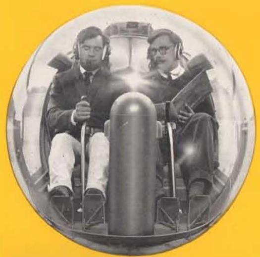
La cabine de pilotage en forme de dôme enveloppant offre une visibilité libre et claire; le plexiglass a d'excellentes qualités optiques et ne fatigue pas la vue.
