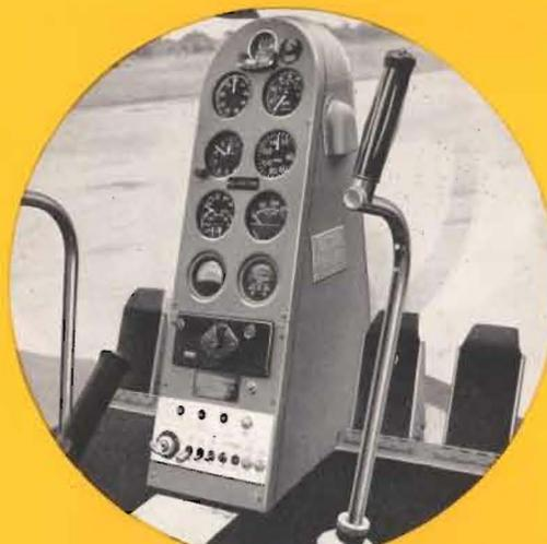
Grâce à une planche de bord où les cadrans ont été réunis de façon à permettre un contrôle général facile, le pilote peut lire ses instruments instantanément.
